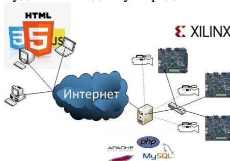
Рис.6. Структура организации удаленного доступа к виртуальной ПЛИС-лаборатории.
