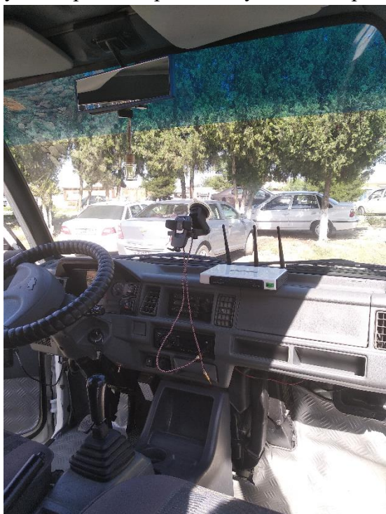
1- расм. “Дамас” автомобилига ўрнатилган бошқарувчи интеллектуал тизим
